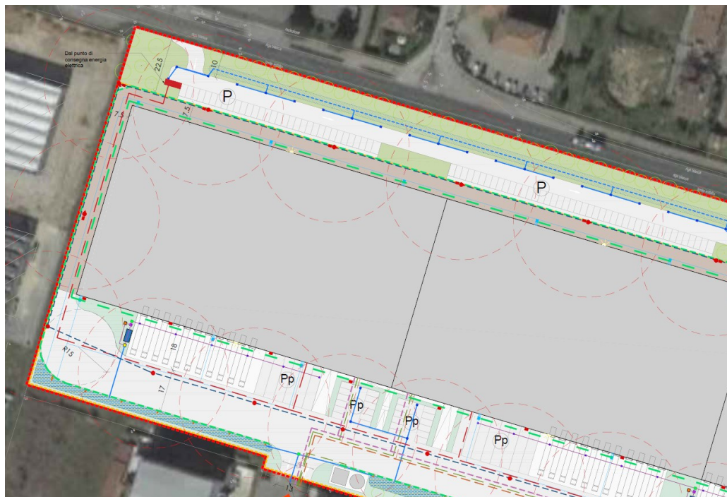
Figura 2-11 – Progetto di invarianza idraulica e idrologica – Planimetria di gestione delle acque
