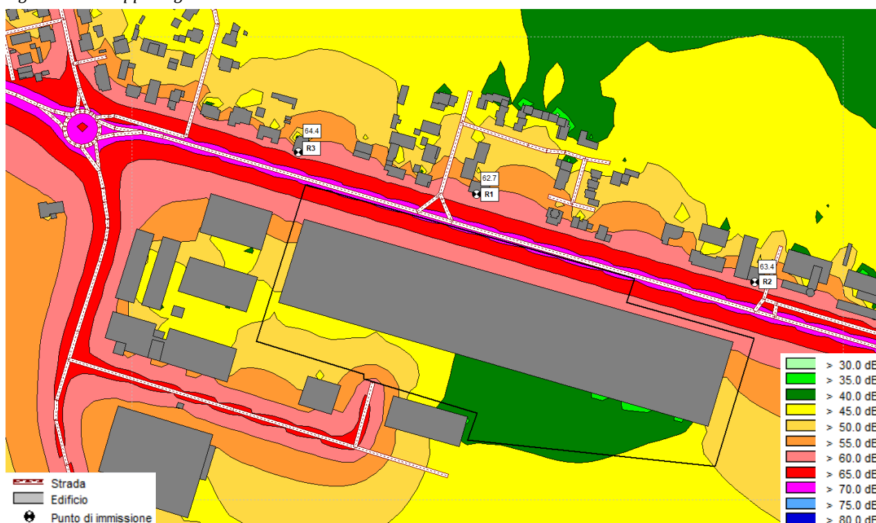
Figura 6-4 - Mappa degli isolivelli acustici DIURNI calcolata a 4 metri di altezza dal suolo - Scenario di intervento.
