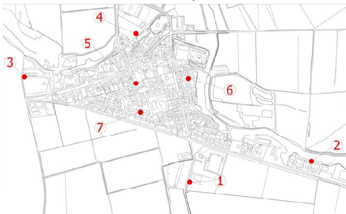
Figura 5-28 – Posizioni e risultanze dei rilievi fonometrici (Relazione tecnica – Classificazione acustica comunale)
