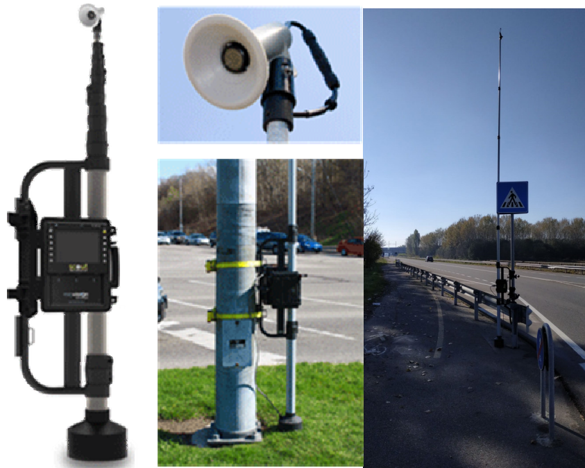
Figura 15 – Strumentazione video con palo telescopico
