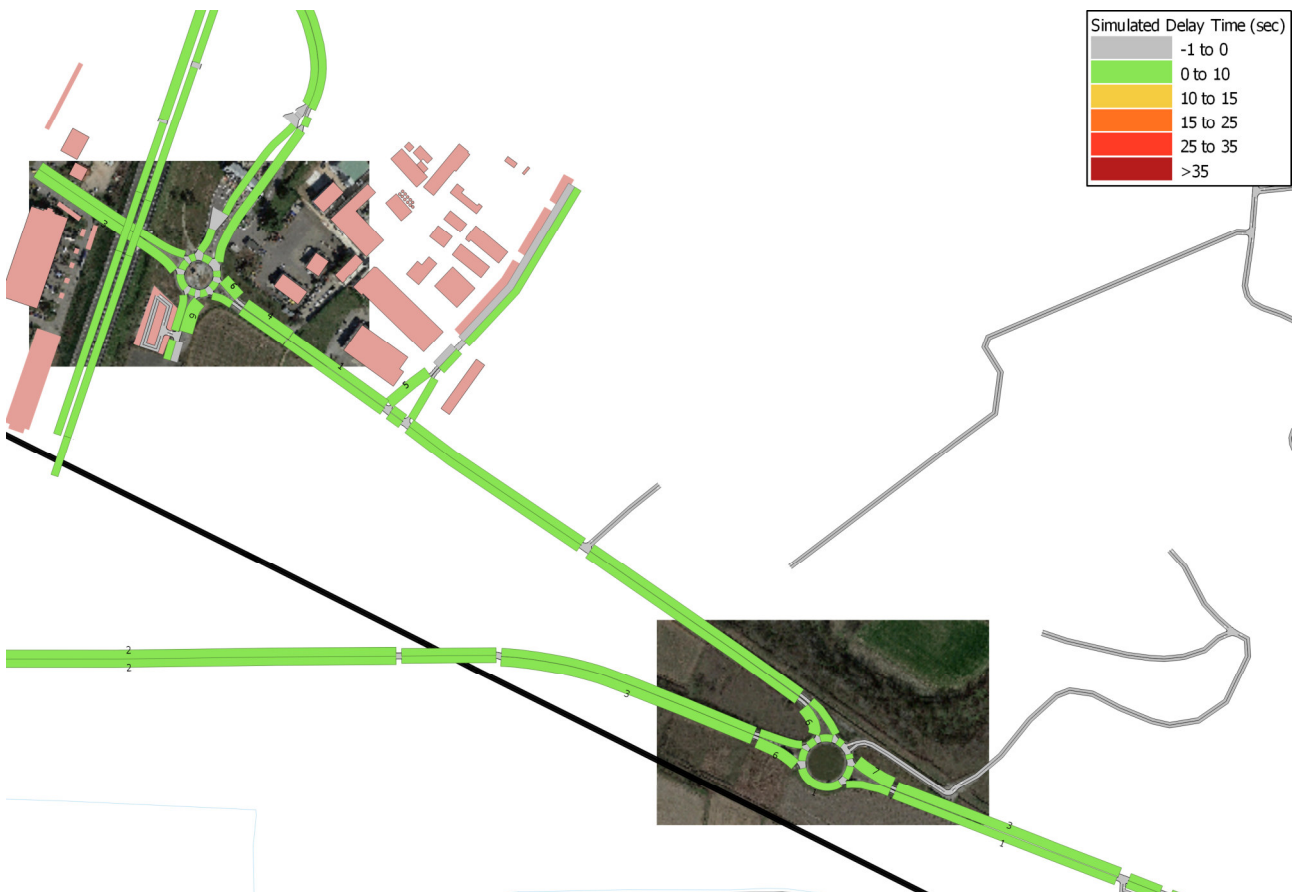
Figura 57 – Perditempo medio veicolare rete stradale area di studio – scenario di progetto – accesso A7
